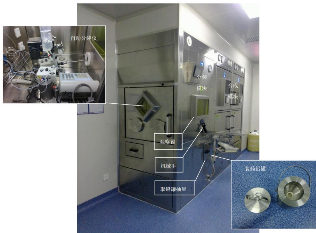
图 3-6 模块箱构造图
