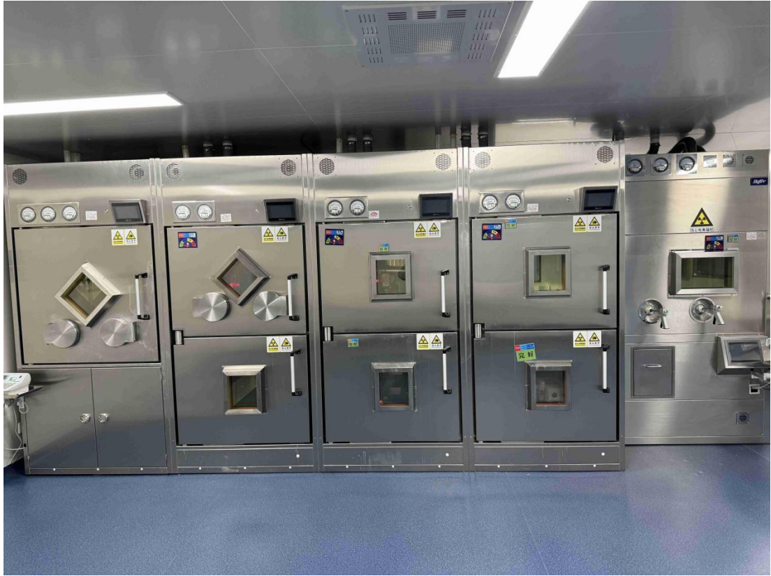
图 4-19 生产车间三合成和分装模块箱
