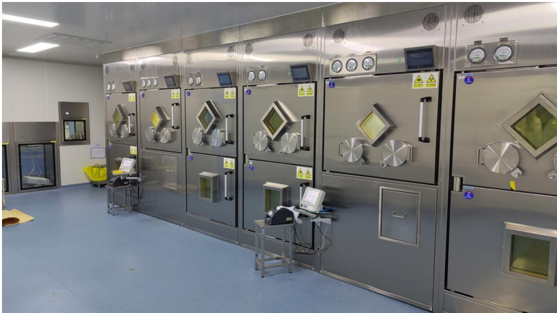
图 4-20 研发合成室 2 合成和分装模块箱
